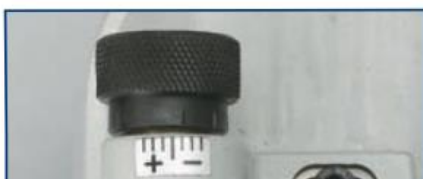
1 Índice copiador con regulación micrométrica.
